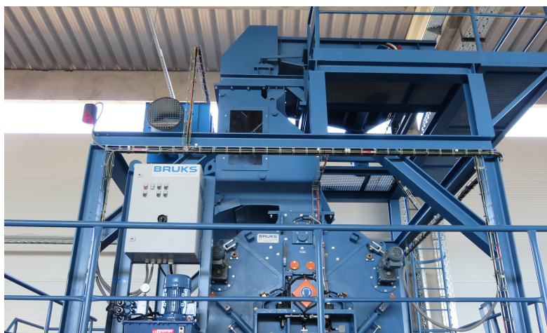
Broyeur à marteaux avec unité d'alimentation
