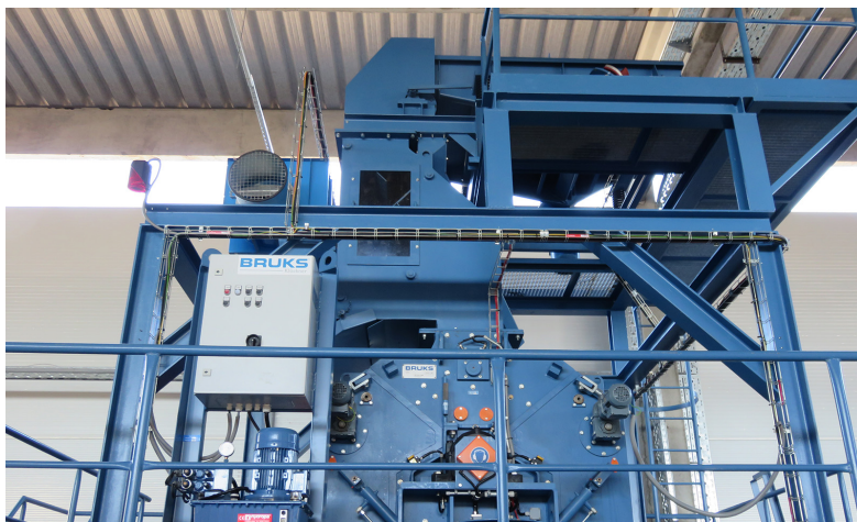
Hammermühle mit Zuführung
