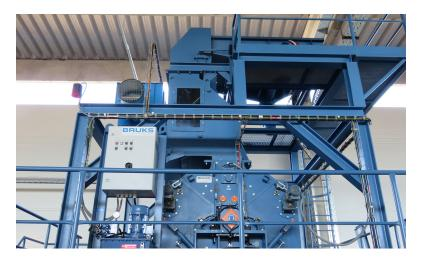
Hammermühle mit Zuführung
