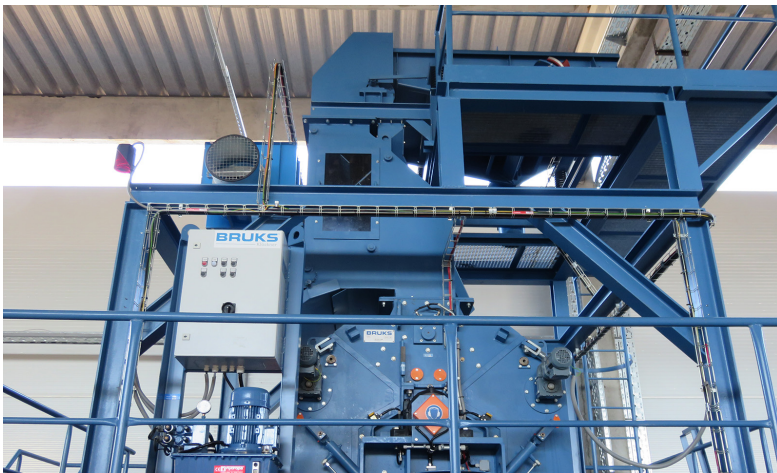
Hammermühle mit Zuführung
