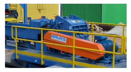
Rotom Hammer Hog mit Einzugseinheit
